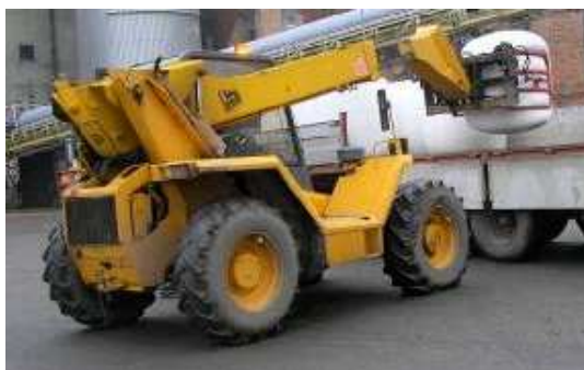
Fig. 1. Loading sugar beet pulp: a - directly from the feeder of the sugar factory line to the hopper of the preheater; b - using telescopic loader with gripper to cylindrical bales Rys. 1. Załadunek wyśtoków buraczanych: a – bezpośrednio z podajnika linii technologicznej cukrowni do kosza zasypowego prasowijarki; b – za pomocą ładowarki teleskopowej z chwytakiem do cylindrycznych bel
