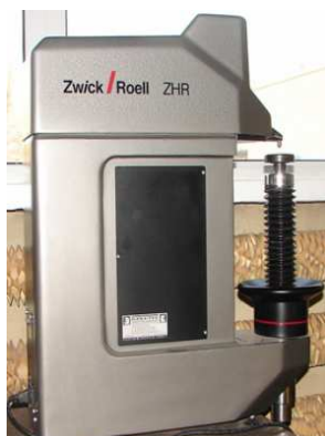
Rys. 5. Twardościomierz „Zwick” Rockwell’a ZHR.4150 AK Fig. 5. Hardness tester “Zwick” Rockwell’a ZHR.4150 AK
