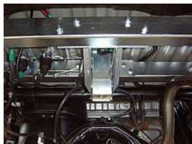
Fig. 10. Hitch ball frame
