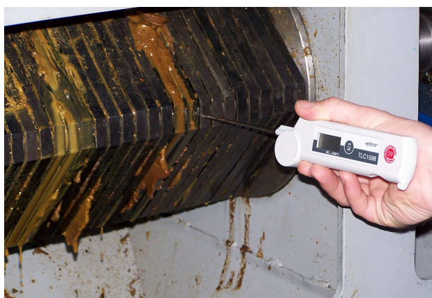
Rys. 3. Pomiar temperatury wytłoczonego oleju wypływającego ze szczelin obudowy ślimaka tłoczącego prasy Fig. 3. Measurement of the temperature of the effluent oil from the gap in a perpetual screw segments assembly housing
