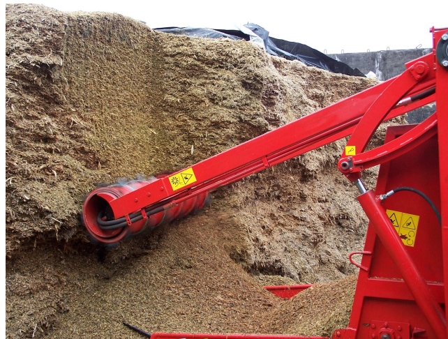
Rys. 3. Wycinanie kiszonki przez frez wybierający uniwersalnego rozdrabniacza
