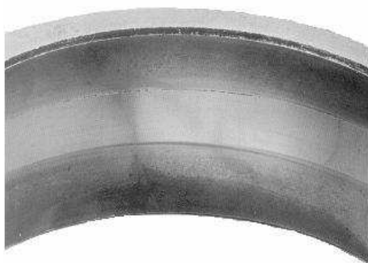
Rys. 4. Zużycie ściernie na powierzchni tocznej łożyska Fig. 4. Abrasive wear on the bearing rolling surface
