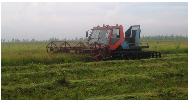
Rys. 7. Ratriak z kombajnowym przyrządem tnącym Fig. 7. Tracked vehicle with harvester cutting instrument Źródło: fot. autorów; Source: authors' photo
