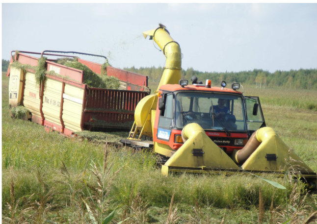
Rys. 6. Agregat ratriak z przyrządem tnącym – przyczepa zbierająca do jednoetapowego zbioru masy zielonej na wodno-błotnych obszarach chronionych
