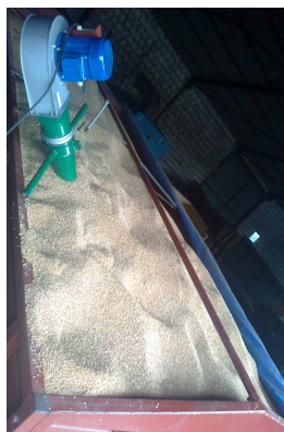
Rys. 2. Stanowisko do pomiaru spadku wilgotności
