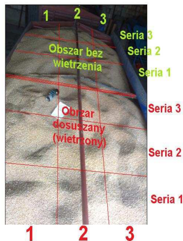
Rys. 3. Schemat rozkładu stref pomiarowych
