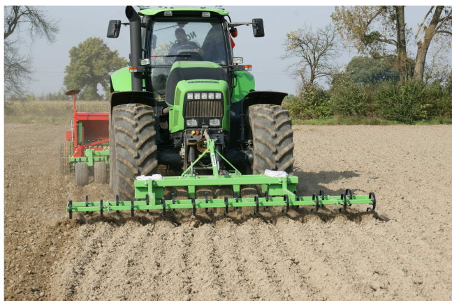
Rys. 6. Koła narzędzia przedniego, ciągnika i agregatu tylnego dociskają wyrównaną glebę
