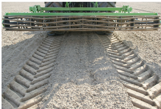
Rys. 5. Głębokie koleiny za kołami ciągnika bez narzędzia przedniego
