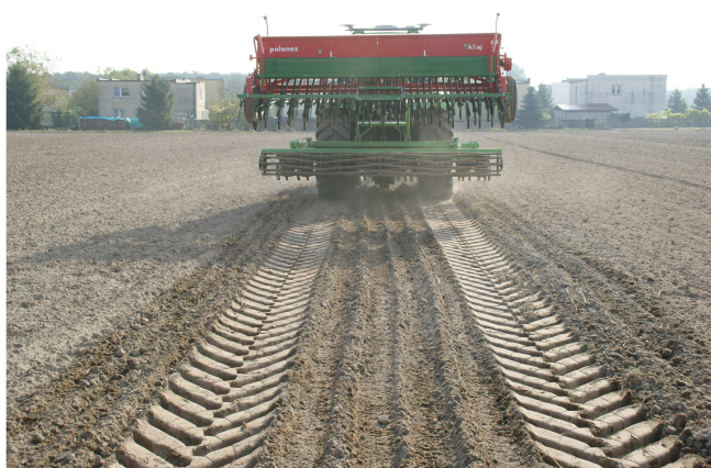
Rys. 7. Płytkie koleiny za kołami ciągnika z narzędziem przednim
