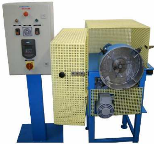
Fig. 1. CIAT machine for continuous abrasive testing [3] Rys. 1. Maszyna typu CIAT do ciągłego badania ściernego [3]
