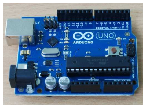
Rys. 1. Płytki uruchomieniowej Arduino Uno (źródło: opracowanie własne)
