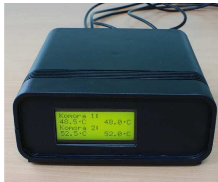
Rys. 4. Jednostka pomiarowa systemu do monitorowania temperatury kompostowanego materiału (źródło: opracowanie własne) Fig. 4. Measurement unit of system for monitoring the temperature of composted material (source: the authors' study)
