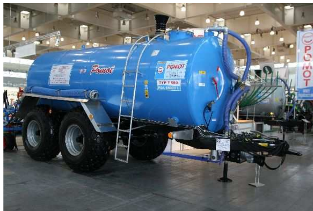
Rys. 4. Modułowy wóz asenizacyjny typ T 550 produkcji Przedsiębiorstwa Usługowo-Produkcyjnego POMOT Sp. z o.o., Chojna
