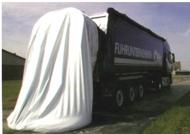
Rys. 2. Bezpośredni załadunek młóta browarnianego do rękawa foliowego Fig. 2. Direct loading of brewer's distillers to a foil sleeve
