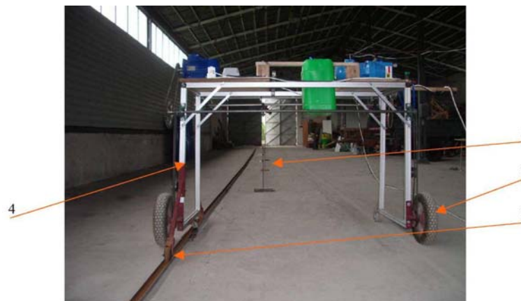
Rys. 6. Widok ogólny stanowiska: 1 – sztuczna roślina, 2 – rolka prowadząca, 3 – koło bieżące 4 – nośnik rozpylaczy Fig. 6. General view of measurement site: 1 – artificial plant, 2 – guide roll, 3 – road wheel, 4 – atomizers' carrier
