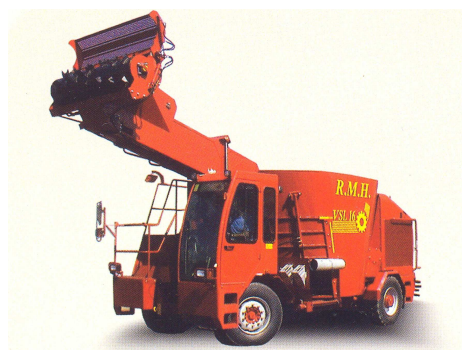
Rys. 5. Wóz paszowy samojezdny samozaładowczy VSL 16 produkcji izraelskiej firmy R.M.H. Lachish Industries Ltd.
