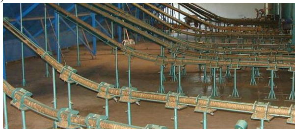
Fig. 1. Stabilizing tracks of various lengths: a) short stabilizing track by Asket [15]; b) long stabilizing track by Carboeco [16] Rys. 1. Tory stabilizujące o różnych długościach: a) tor stabilizujący krótki firmy Asket [15], b) tor stabilizujący długi firmy Carboeco [16]
