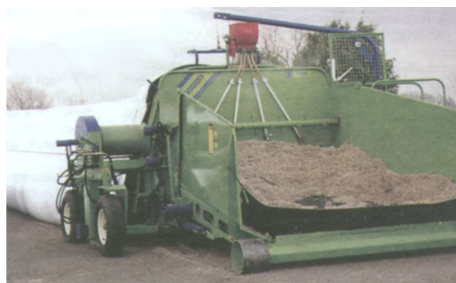
Rys. 3. Napełnianie rękawa foliowego wysłodkami z dozowaniem preparatu konserwującego
