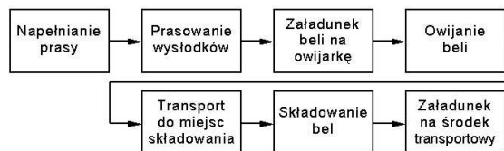
Rys. 4. Schemat blokowy procesu technologicznego zakiszania wysłdków buraczanych w postaci bel cylindrycznych owiniętych folią
