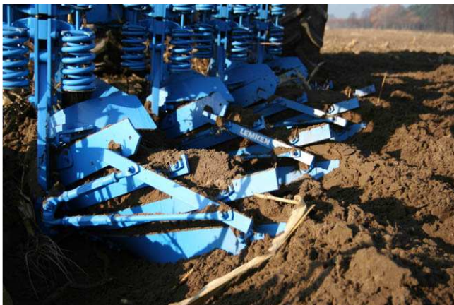
Rys. 2. Korpusy ażurowe pługa firmy Lemken dobrze kruszą glebę i nie zamazują skib
