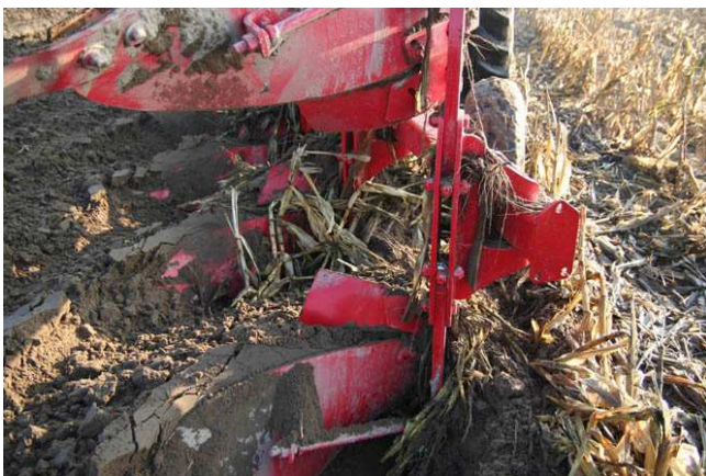
Rys. 4. Ścinacze mocowane powyżej odkładnic wrzucają resztki poźniwe przed skibę
