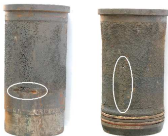
Rys. 5. Uszkodzenie tulei spowodowane przez stosowanie wody w układzie chłodzenia Fig. 5. Damage of cylinder sleeve caused by using water in the cooling system
