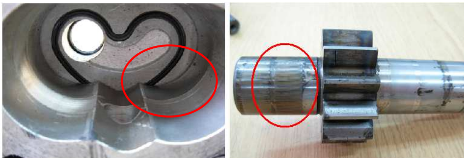
Rys. 6. Uszkodzenie korpusu oraz koła zębatego z wałem napędzanym pompy hydraulicznej Fig. 6. Damage of cause and gear wheel with crankshaft in the hydraulic pump
