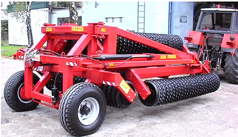
Rys. 1. Wał uprawowy o szerokości 12 m Fig. 1. The 12-meter agricultural roller
