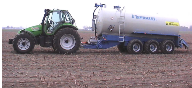
Rys. 1. Ekologiczny wóz asenizacyjny do głębokiego dozowania gnojowicy podczas badań polowych
