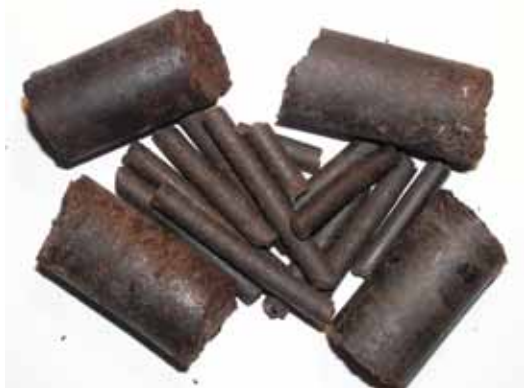
Fig. 8. Briquettes (diameter - 28 mm) and pellets (diameter - 8 mm) from a mixture of buckwheat hulls and potato pulp obtained with the use of a pelletizing and briquetting matrix Rys. 8. Brykiety (średnica - 28 mm) i granulaty (średnica - 8 mm) z mieszaniny łuski gryki i wycierki ziemniaczanej otrzymane z wykorzystaniem matrycy granulująco-brykietującej
