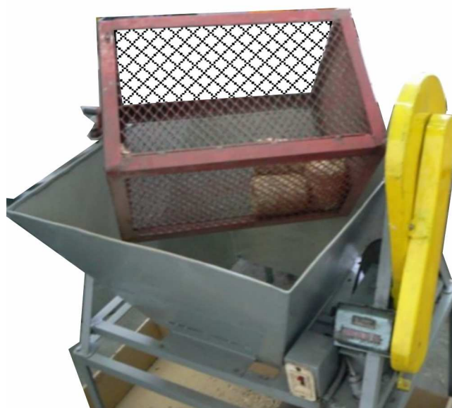
Rys.1. Stanowisko badawcze do wyznaczania współczynnika trwałości brykietów
