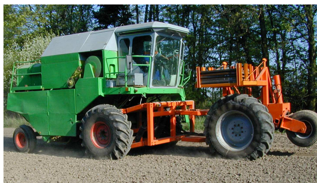
Rys. 11. Urządzenie do badań polowych opon rolniczych Fig. 11. The research mechanism for field tests
