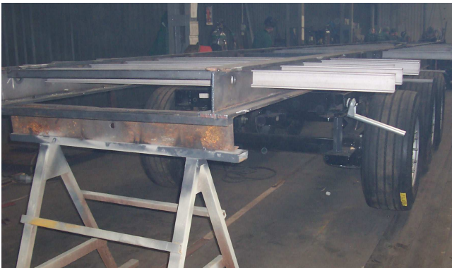
Rys. 3. Rama naczepy w trakcie prac spawalniczych Fig. 3. Frame during workshop welding operations
