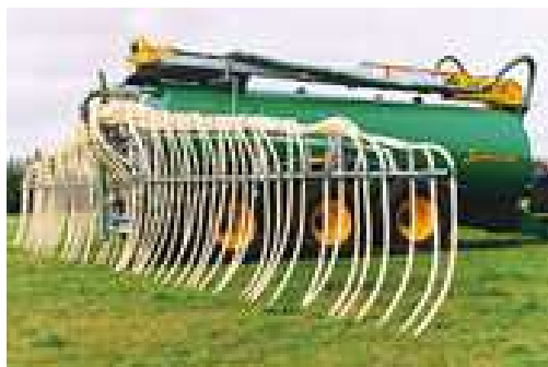
Rys. 3. Przyczepa asenizacyjna do głębokiego wprowadzania gnojowicy SAMSON PG produkcji SAMSON AGRO A/S, Dania
