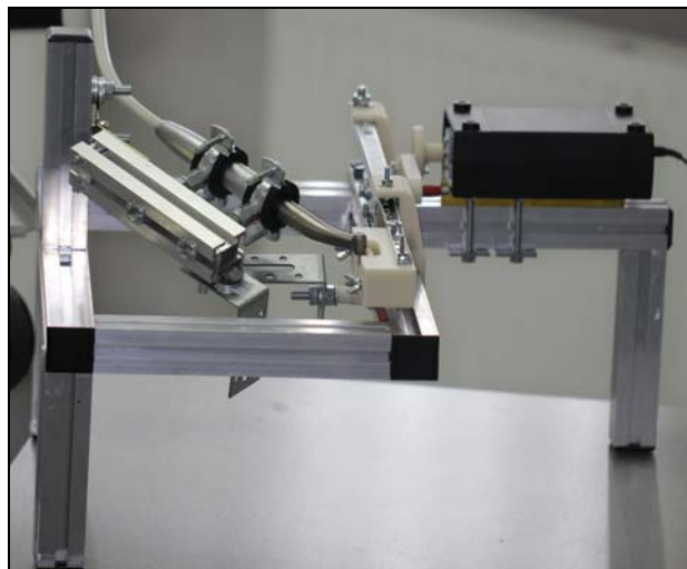
Rys. 10. Stanowisko badawcze z zamontowaną wiertarką turbinową
