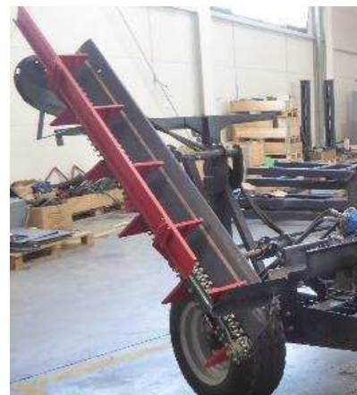
Fig. 10. Chain conveyor in transport position Rys. 10. Przenośnik łańcuchowy brykietów w pozycji transportowej
