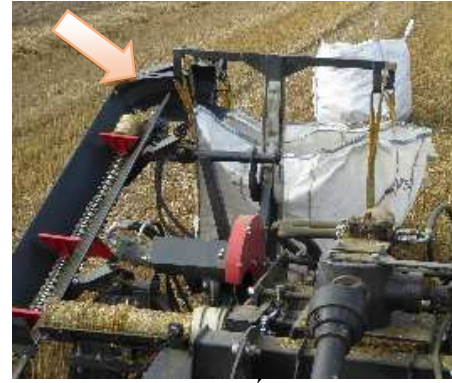
Fig. 9. Turning bend (marked with an arrow) and the Big-Bag in the end of the machine Rys. 9. Kolano kierujące brykiet (zaznaczone strzałką) oraz worek Big-Bag z tyłu maszyny
