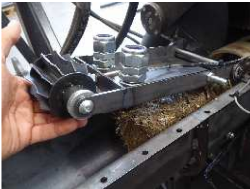
Fig. 7. Counting roller Rys. 7. Rolka zliczająca długość brykietu
