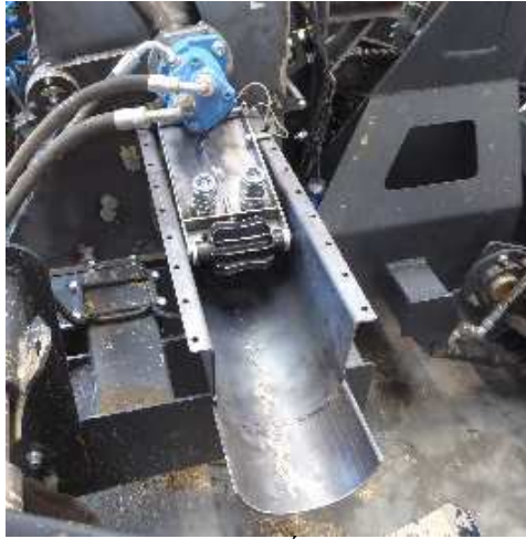
Fig. 6. Briquette transporting chute Rys. 6. Rynna transportująca brykiet
