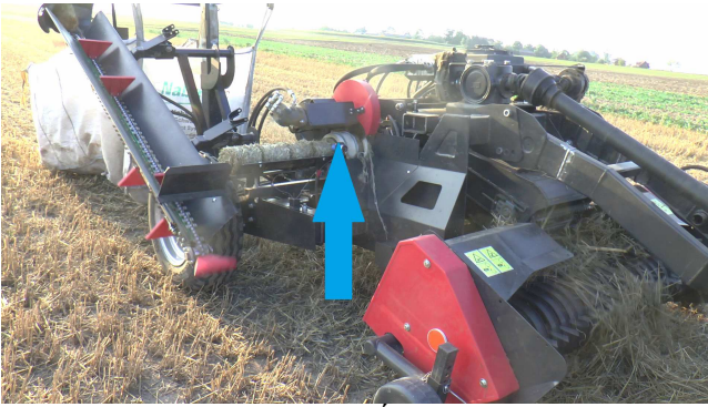
Fig. 3. Briquette cutter mounted on machine Rys. 3. Zespół cięcia brykietu zamontowany na maszynie
