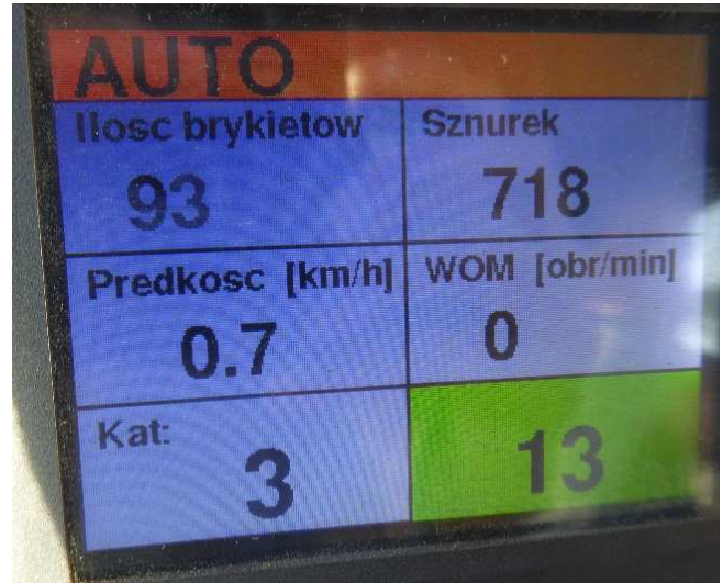
Fig. 5. Display shows thread usage in meters (Sznurek) Rys. 5. Wyświetlacz wskazujący zużycie nici w metrach (Sznurek)
