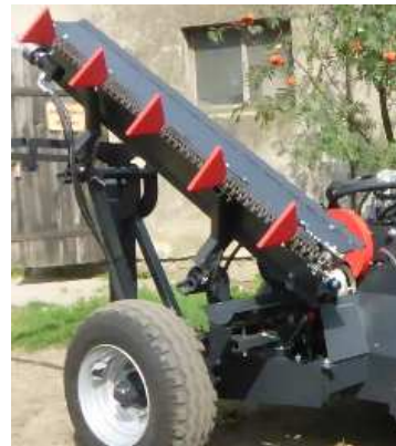
Fig. 10. Chain conveyor in transport position Rys. 10. Przenośnik łańcuchowy brykietów w pozycji transportowej
