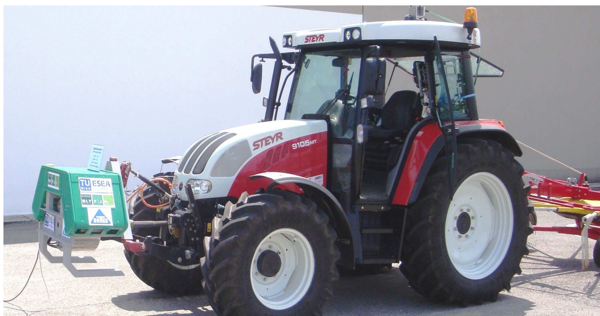
Rys. 1. Zespół prądotwórczy na przedni TUZ skonstruowany przez zespół konstruktorów TU w Wiedniu [10] Fig. 1. Generating set for front three-point linkage constructed by a team of machinists at TU in Vienna [10]
