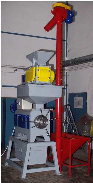
Rys. 2. Zestaw urządzeń przeznaczonych do wyciągania oleju z nasion lnianki siewnej i innych oleistych roślin drobnoziarnistych Fig. 2. The set of devices intended to the optimum oil extraction from seed of Camelina sativa L. and other fine-grained oil plants
