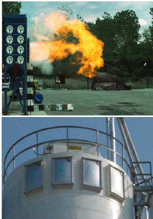
Rys. 4. Uwolnienie wybuchu za pomocą klap bezpieczeństwa (badania) oraz klap bezpieczeństwa zainstalowane na rzeczywistym silosie
