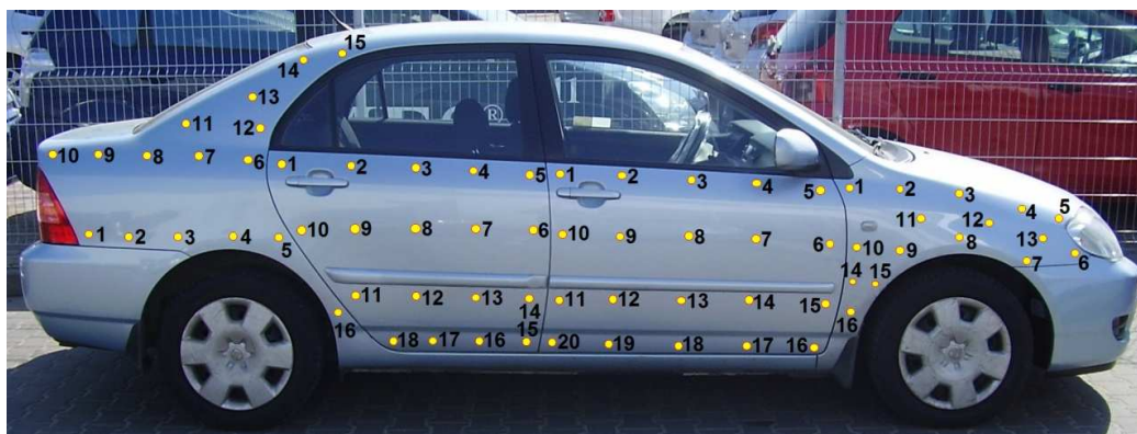
Rys. 3. Siatka punktów pomiarowych badanych elementów pojazdów – seria 2, 3, 4, 5 Fig. 3. Grid points tested vehicles components – series 2, 3, 4, 5
