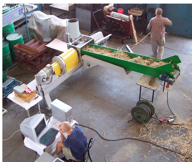
Rys. 2. Stanowisko badawcze do badania procesu brykietowania słomy metodą zwijania
