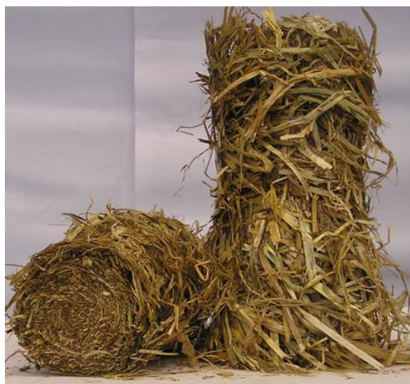
Rys. 2. Brykiety ze słomy owsa odmiany Chwat Fig. 2. Briquettes from straw of oat varieties Chwat
