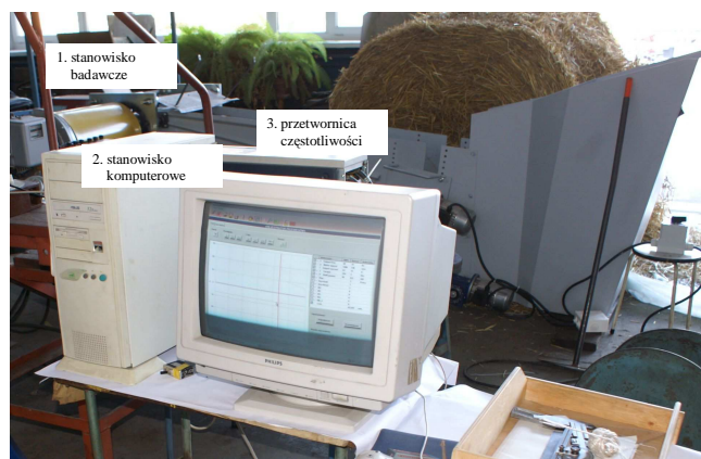
Rys. 1. Stanowisko badawcze do badania procesu brykietowania słomy metodą zwijania
