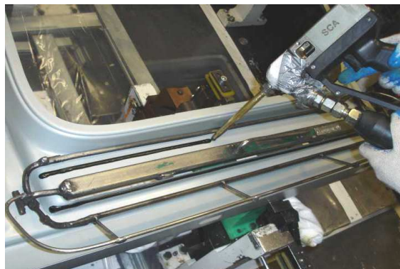
Rys. 1. Przykładowe zastosowanie kleju: a) klejenie poszycia dachu samochodu osobowego [8], b) nakładanie kleju w obrębie mocowania prowadnicy drzwi pojazdu osobowego [9]
