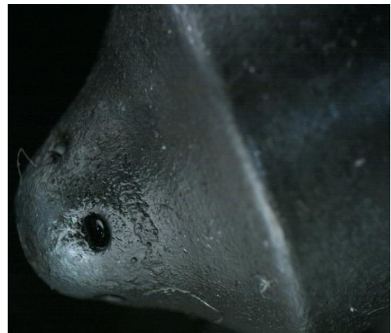
Fig. 9. Carbon in the area of nozzle holes (Bosch Common Rail nozzle) [16] Rys. 9. Nagar w rejonie otworów rozpylających (rozpylacz Common Rail Bosch) [16]
