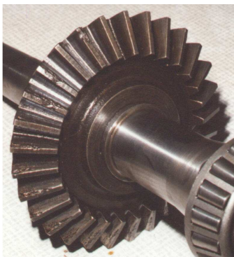
Rys. 5. Widok wykruszeń (pittingu) po badaniach na kole o zębach prostych Fig. 5.
