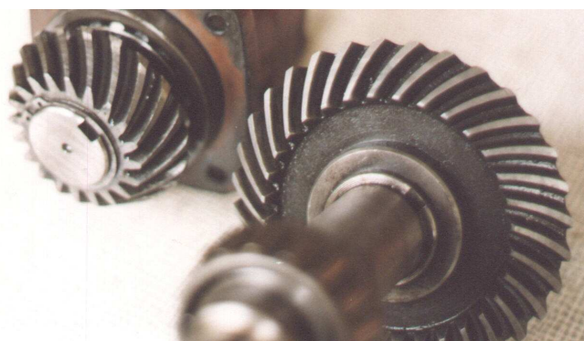
Rys. 4. Koła o zębach łukowych Fig. 4. Wheels with teeth
