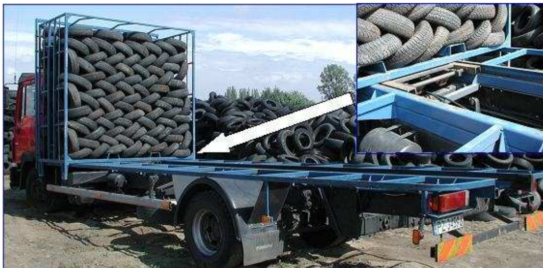
Rys. 1. Widok ogólny samochodu z zabudowaną na nim ramą nośną i załadowanym kontenerem Fig. 1. The truck with carrying frame and full container – general view
