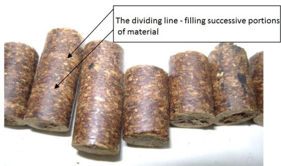
Fig. 6. View of the granulate (obtained with the parameters: l_m = 42 mm and m_p = 0,6 g) with visible dividing lines resulting from backfilling of subsequent raw material samples Rys. 6. Widok granulatu (otrzymanego przy parametrach: l_m = 42 mm oraz m_p = 0,6 g) z widocznymi liniami podziału wynikającymi z zasypywania kolejnych próbek surowca
