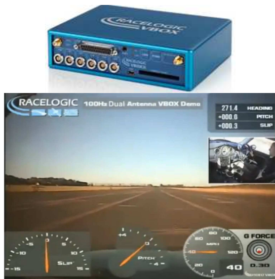
Rys. 3. Aparatura pomiarowa V-BOX RACELOGIC oraz zintegrowany sposób prezentacji wyników pomiarów; źródło: http://www.racelogic.co.uk/index.php/en/our-products Fig. 3. V-BOX RACELOGIC measuring apparatus and integrated form of measured results presentation; source: http://www.racelogic.co.uk/index.php/en/our-products
