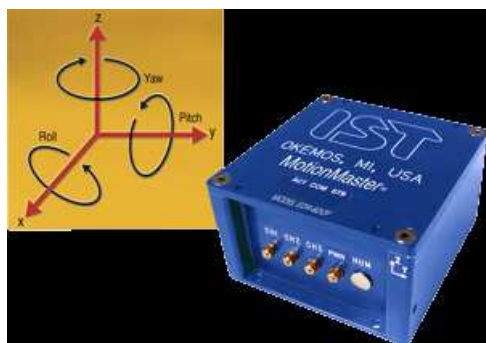
Rys. 4. Widok urządzenia firmy IST, służącego do pomiaru przyspieszeń oraz prędkości kątowych w trzech wzajemnie prostopadłych kierunkach; źródło: http://www.isthq.com/ Fig. 4. View of apparatus produced by IST company, used for measurements of accelerations and angular velocities in three mutual perpendicular directions; source: http://www.isthq.com/
