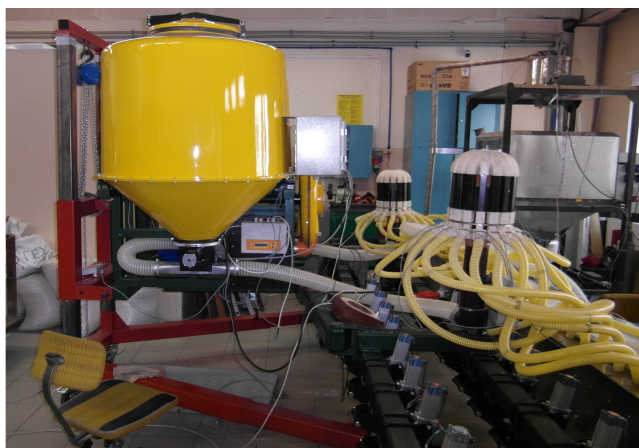
Rys. 1. Prototypowy eksperymentalny siewnik rzędowy mechaniczno-pneumatyczny do wysiewu zbóż z elektronicznym sterowaniem wysiewu na stanowisku laboratoryjnym
