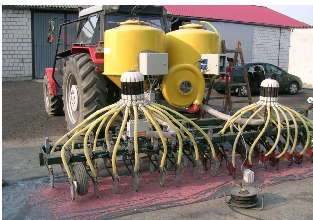
Rys. 2. Eksperymentalny siewnik rzędowy mechaniczno-pneumatyczny do wysiewu zbóż z elektronicznym sterowaniem wysiewu, przygotowany do badań polowych
