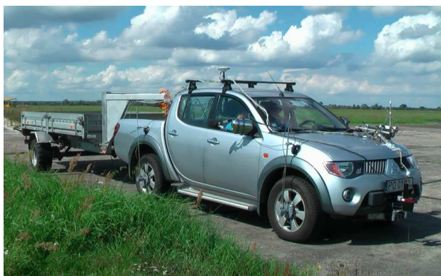
Rys. 5. Pojazd przeznaczony do badań stateczności ruchu oraz kierowności
