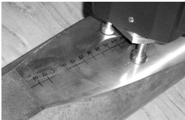
Rys. 1. Badanie skuteczności zabiegów obróbki cieplnej przez pomiar twardości w głąb hartowanego wlewka Fig. 1. Testing the effectiveness of heat treatment (austempering) by measurement of through-hardness in an austempered keel block
