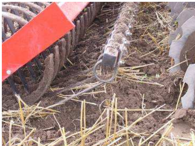
Rys. 4. Zgrzebło wprowadza resztki poźniwne pod wał Fig. 4. Curry-comb passes the after-crop remains under the shaft
