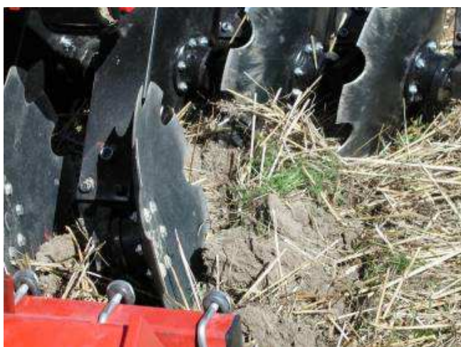
Rys. 2. Talerze podcinają i mieszają ściernisko z glebą Fig. 2. Discs cut and mix the stubble with soil
